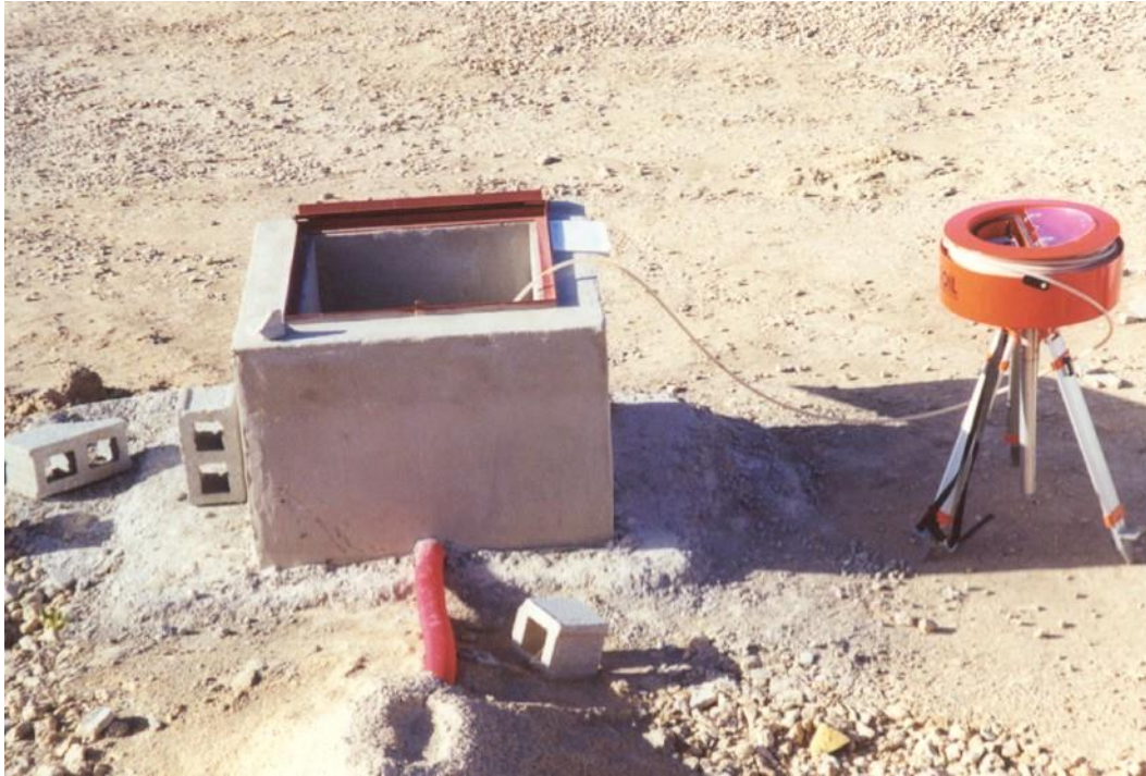
Fig. 2.- Elementos de la línea continua de asientos (LCA).
