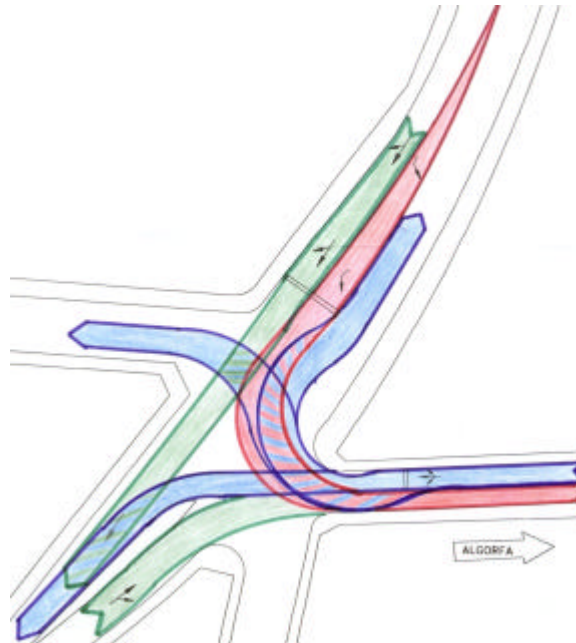
Figura 10: Planta de trayectorias en una intersección en Benejuzar (Alicante)
