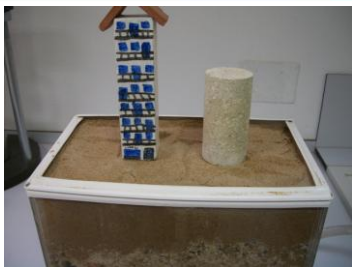
El nivel freático llega a la superficie
