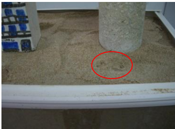
El terreno empieza a burbujear en zonas localizadas
