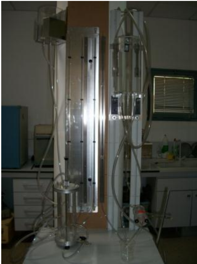
Figura 3. Estado preliminar del montaje de las prácticas para el ensayo pinhole y el ensayo de permeabilidad con un permeámetro de carga constante.
